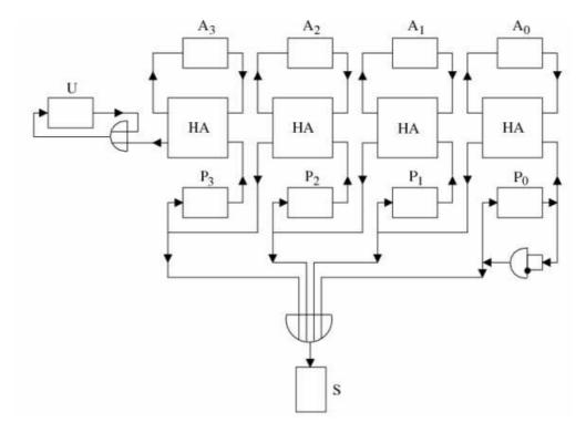
(a) Simulieren Sie die Arbeitsweise eines Von-Neumann-Addierwerkes indem Sie die nachfolgende Tabelle ausfüllen. Die zu addierenden Werte 11 und 13 stehen bereits im Akku bzw. im Puffer. (4 Punkte)
