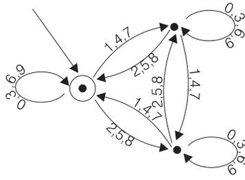
Dieser Automat  $\mathcal{A}$  ist *deterministisch*, d.h. für jeden Zustand  $p$  und jeden Buchstaben  $a$  existiert genau eine Transition der Form  $(p, a, q)$ .
